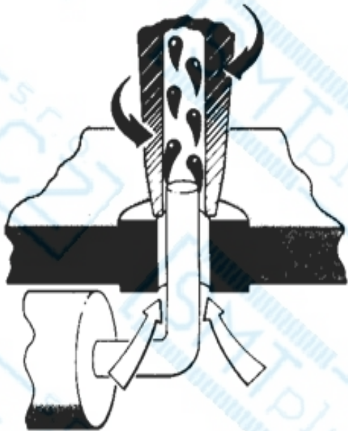
Obr. 3-58 Odpájení vývodové součástky
